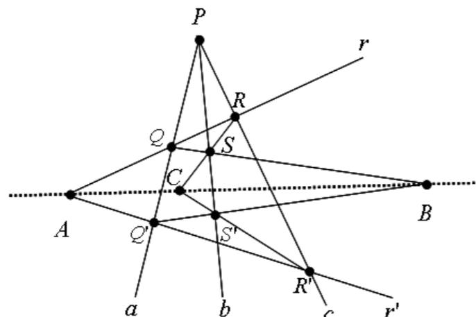
Figura 1. Construcción de la recta  $AB$  con una regla de longitud  $\epsilon$  (menor que la distancia entre  $A$  y  $B$ ).
