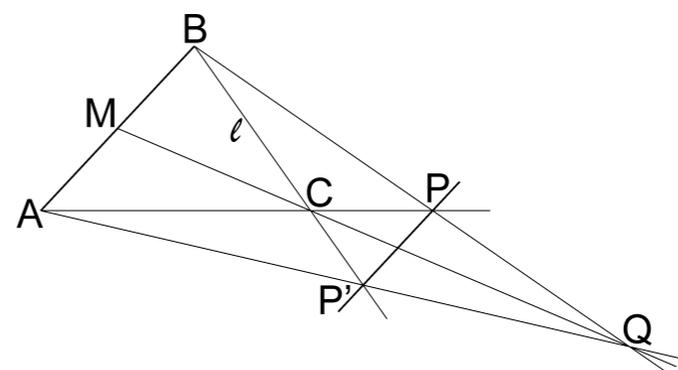
Figura 2. Construcción de la recta paralela  $AB$ , dado el punto medio  $M$ .
