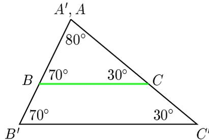
Aquí podemos observar que los lados  $BC$  y  $B'C'$  son paralelos, y de manera inversa, si nosotros trazamos una línea paralela a uno de los lados de un triángulo de manera que ésta corte a los dos lados restantes, entonces esta línea paralela cortará un triángulo semejante al triángulo original.
